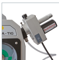
Module d'affûtage - rotation automatique du porte-électrode
