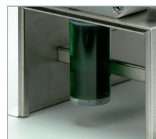
Réceptacle hermétique pour la collecte et le recyclage de la poussière.
